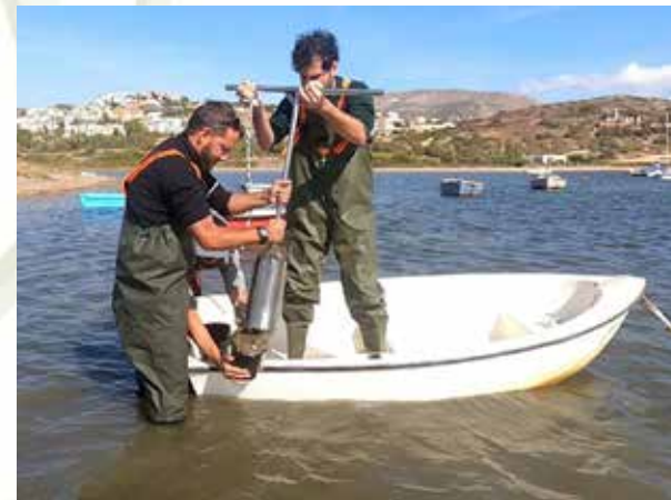
Σχηματική αναπαράσταση του ειδικά διαμορφωμένου εργαλείου για την εξαγωγή – μεταφύτευση θαλάσσιας βλάστησης και επίδειξη χρήσης του στο πεδίο.
